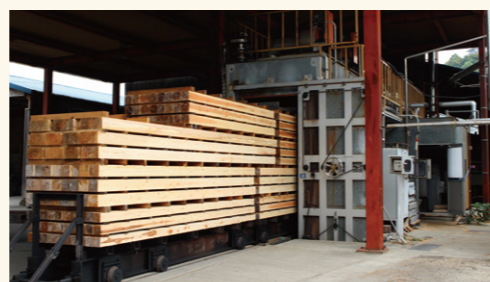
人工乾燥機を2台設置し、お客様の要求に応じ「低温」「高温」の乾燥システムを選択できます。最長12mの木材まで乾燥ができます。
