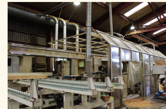
プレカット加工機。長さ10mを超える 梁・桁から、板、造作材まで、お客様の注文に応じて木を加工することができます。
